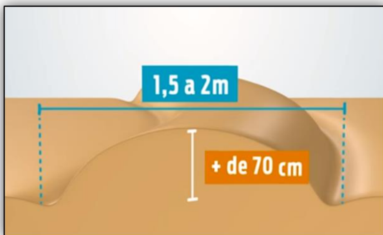
Figura 22 - Caracterização geral de um terraço agrícola.
